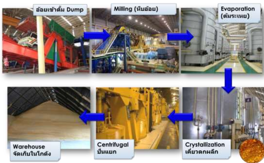
ภาพที่ 2.1 กระบวนการผลิตน้ำตาลทรายดิบ
